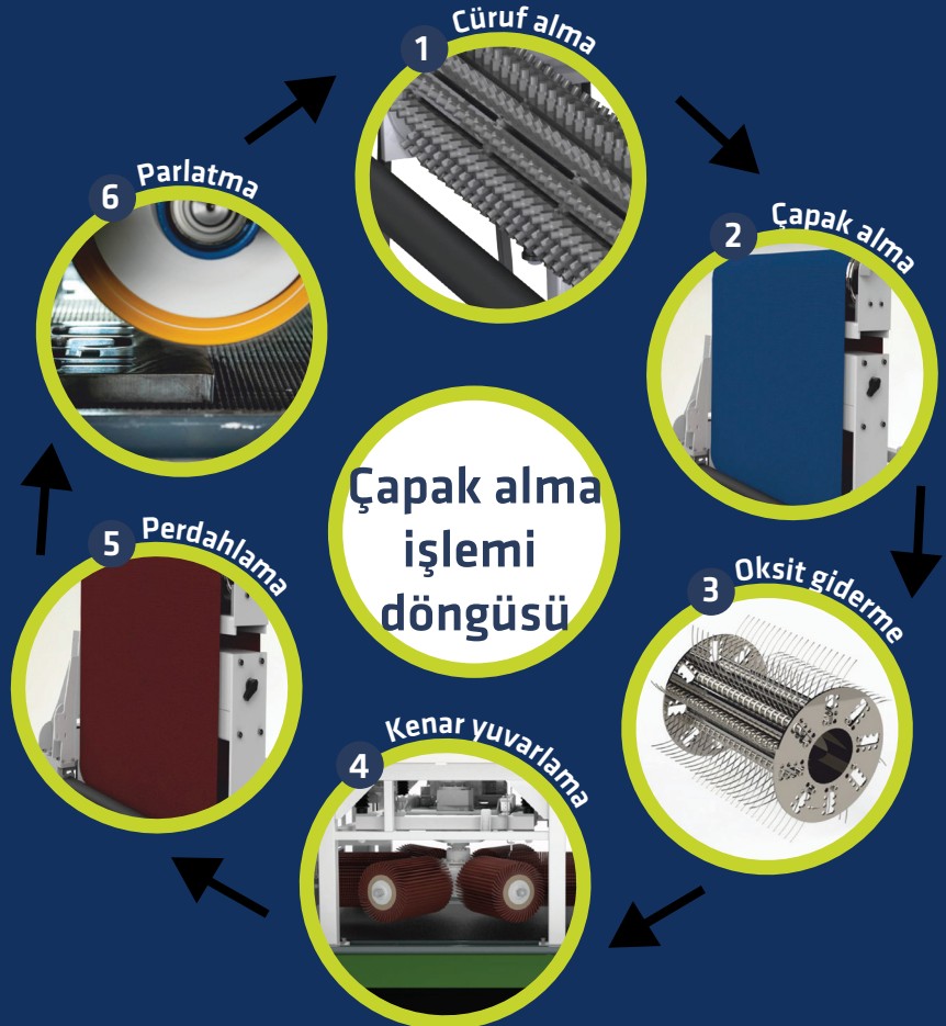
Örnek 3 modüllü modül yapısı: 2 Çapak Alma, 4 Kenar yuvarlama ve 5 Perdahlama
